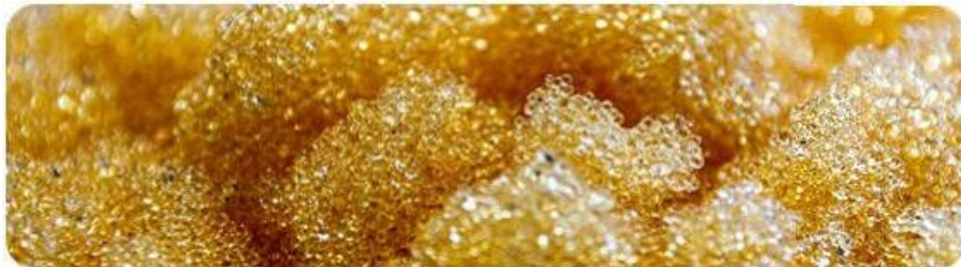
**LVDex-120** монодисперсная сильнокислотная катионообменная смола гелевого типа на основе сульфонированного полистирола. Её основными характеристиками являются превосходная физическая и химическая стабильность, термостойкость и хорошая ионообменная кинетика. Монодисперсный катионит LVDex-120U используется для обессоливания воды в промышленном производстве пара в прямоточных и противоточных системах, а также в фильтрах смешанного действия в комбинации с анионитами LVDex.
