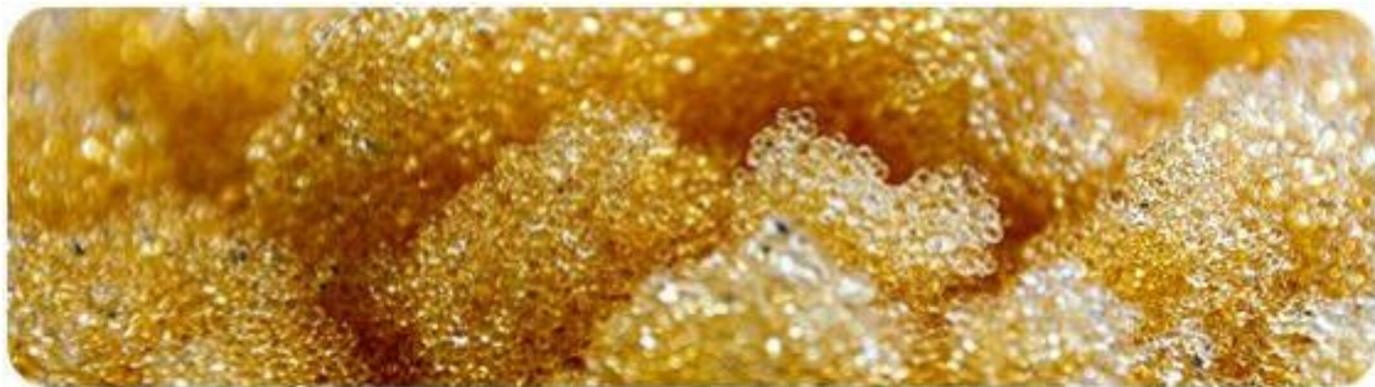
**LVDex-120** сильнокислотная катионообменная смола гелевого типа на основе сульфонированного полистирола. Её основными характеристиками являются превосходная физическая и химическая стабильность, термостойкость и хорошая ионообменная кинетика. LVDex-120 используется как для умягчения воды (в Na-форме), так и для обессоливания воды (в H-форме) в установках с параллельноточной регенерацией. LVDex-120 пригодна для промышленного использования.
